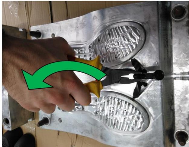
Figura 4: Extracción de la mazarota.
