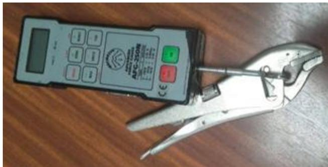
Figura 9: Dinamómetro y alicate de presión acoplados para la toma de medidas.
