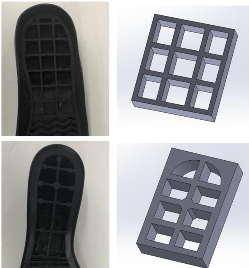
Figura 20: Detalle ahorros de las suelas y modelos 3D generados.
