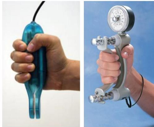
Figura 5: Dinamómetros comerciales.<sup>1 y 2</sup>
